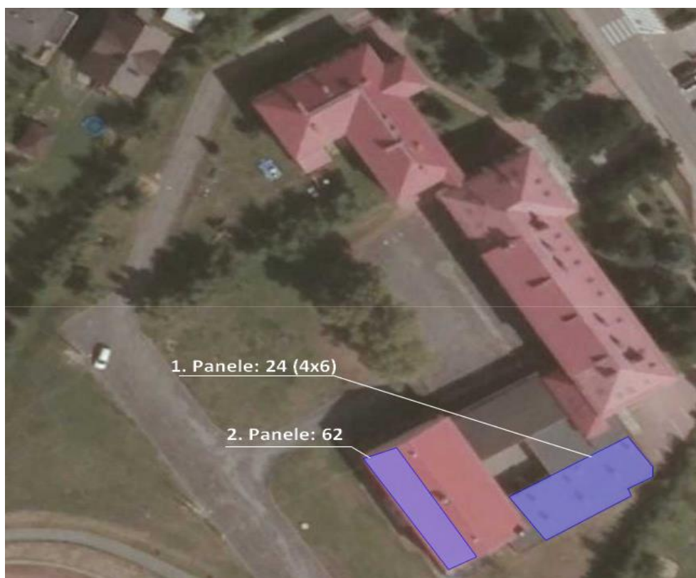
Rys. 23. Pola modułów na dachu budynku Gimnazjum w Rudzicy
