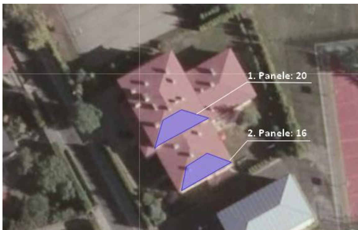
Rys. 19. Pola modułów PV na dachu budynku Przedszkola Publicznego w Świątoszówce
