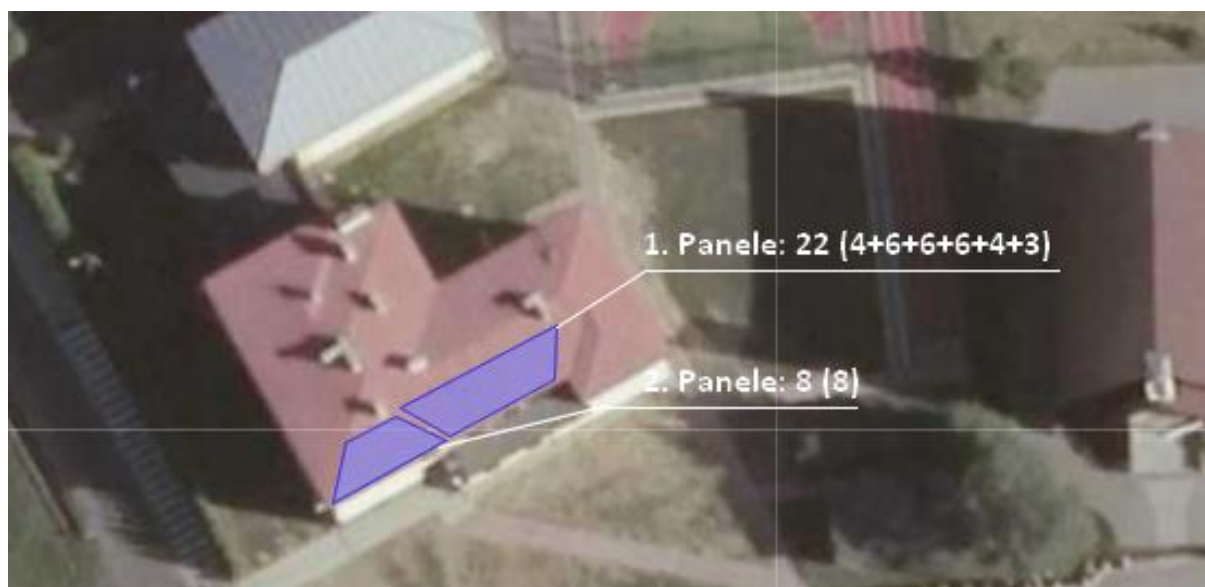
Rys. 18. Pola modułów PV na dachu budynku szkoły podstawowej
