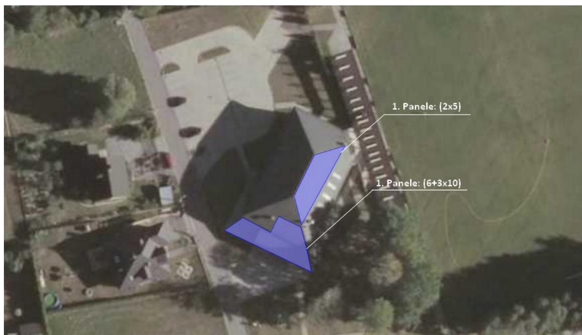
Rys. 16. Pola modułów PV na dachu budynku Gminnego Ośrodka Kultury w Jasienicy
