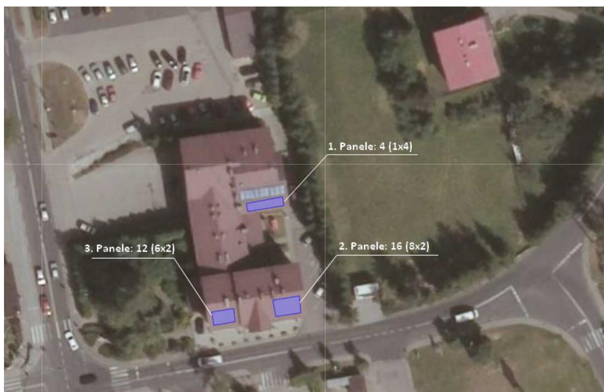
Rys. 13. Pola modułów PV na dachu budynku Urzędu Gminy w Jasienicy
