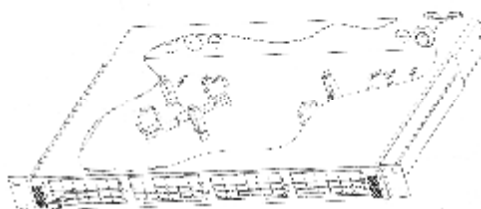
Rys.7 Panel krosowy 24 porty MT-RJ niezaladowany, 1U
