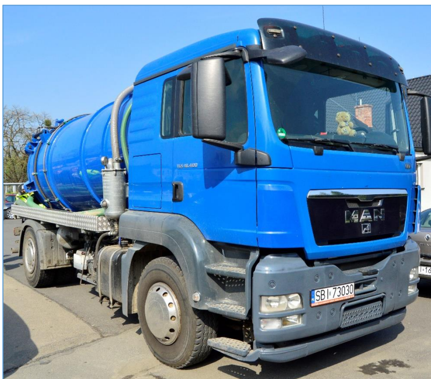
Zdjęcie 33. Wóz asenizacyjny, przeznaczony przede wszystkim do wywozu ścieków z posesji
