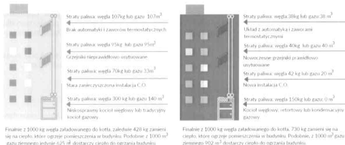
Rysunek 6-3 Przykładowe porównanie, starej i nowej instalacji grzewczej
